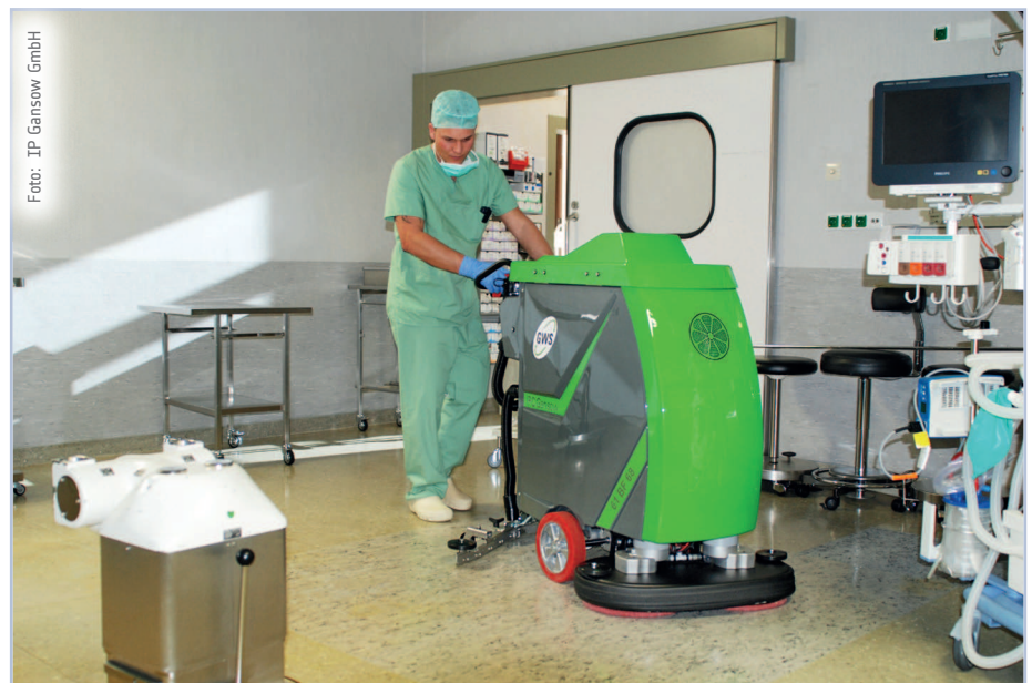
Maschinelle Fußbodenreinigung mit HEPA-Filter in einem MRSA-OP.
